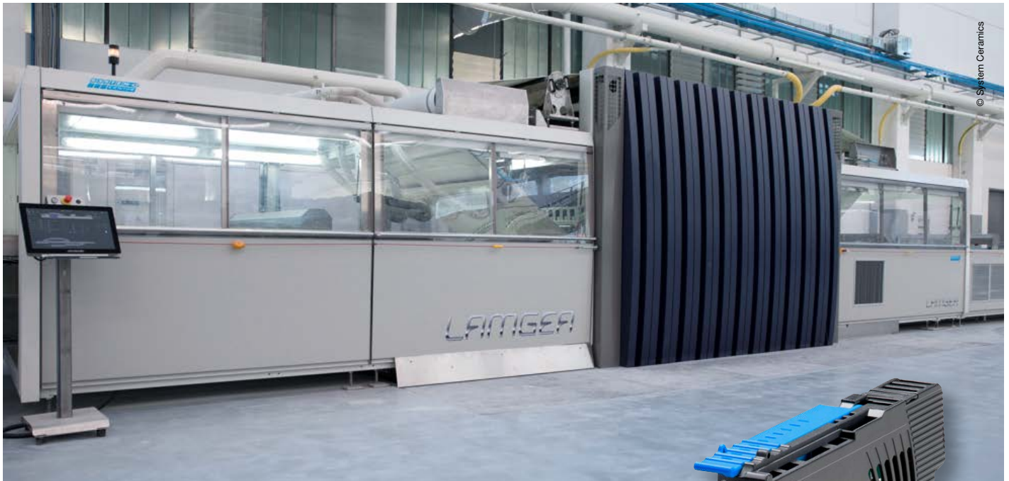
LAMGEA presst das Material ohne Form, daher kann sich die Platte ausdehnen und es treten keine Materialspannungen auf.
