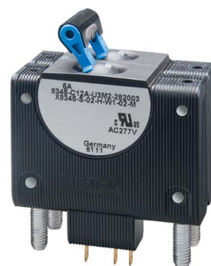
2-poliger hydraulisch-magnetischer Schutzschalter mit integrierten Hilfskontakten
